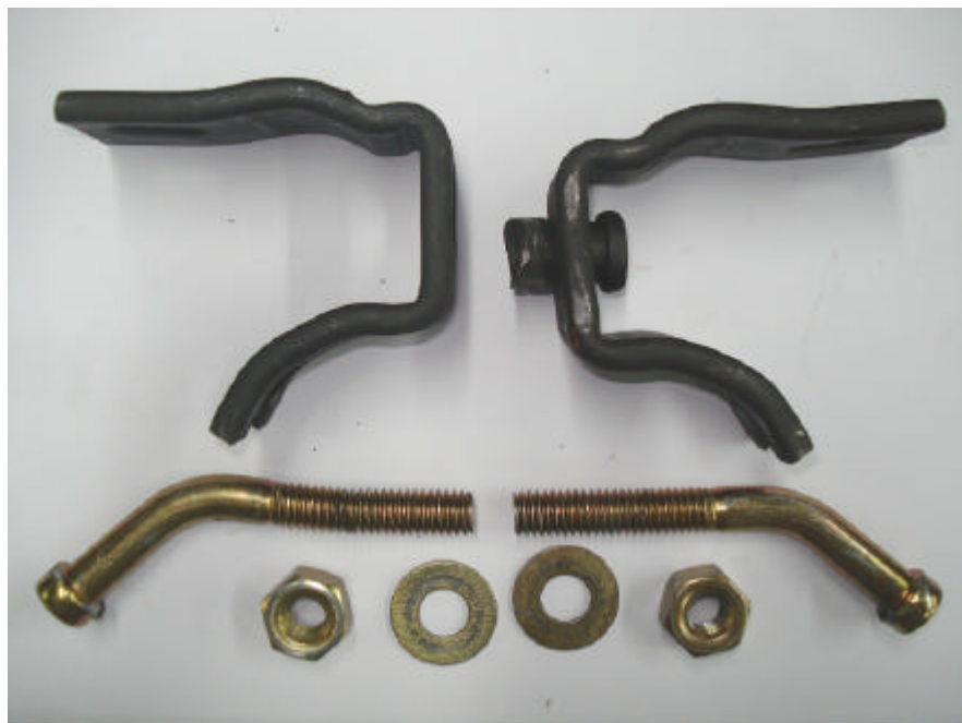
FOTO N.º 06 – CORPO DE PROVA APÓS A REALIZAÇÃO DO ENSAIO DE TRAÇÃO
