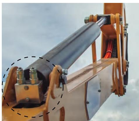
Válvulas acopladas aos cilindros hidráulicos, maior segurança e confiabilidade.
