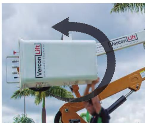
Todas unidades contam com sistema de basculamento da caçamba facilitando a limpeza e drenagem de água.
