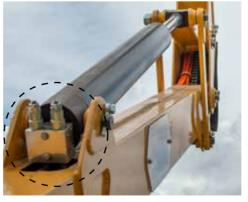
Válvulas acopladas cilindros aos hidráulicos, maior segurança confiabilidade.
