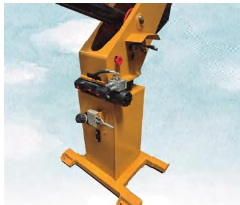
Sistema de giro contínuo (infinito) e equipado com válvula de contrabalanço.
